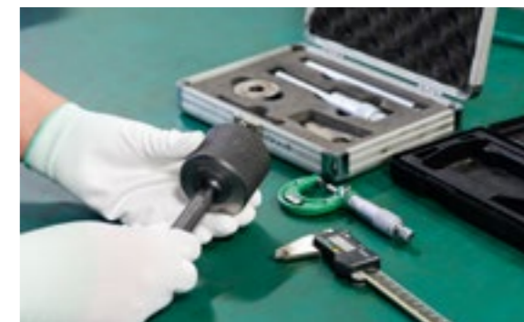
使用通止规检测压座孔的轴承
